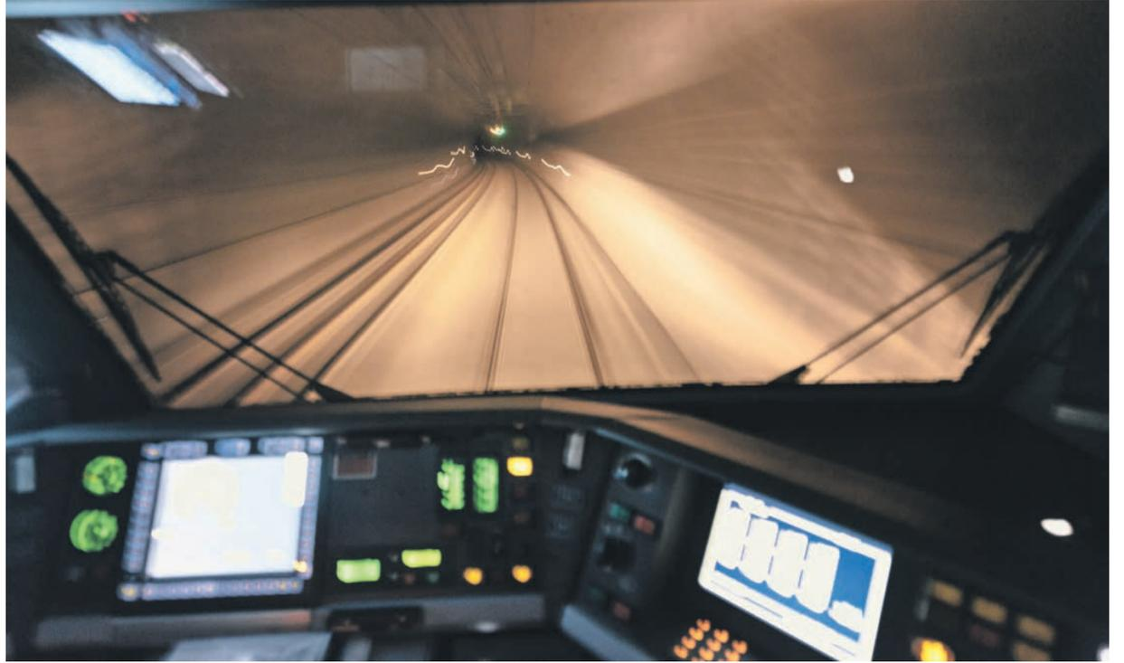
**Zweigleisig.** Durch den Teilausbau wird sich die Länge der zweispurigen Strecke im Lötschberg-Basistunnel von heute 14 Kilometer auf 28 Kilometer verdoppeln.
